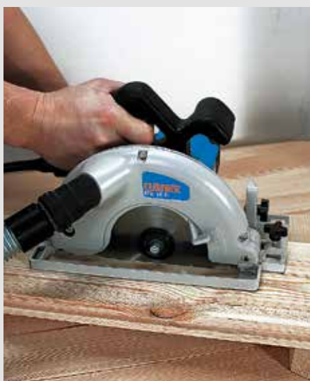
Připojení kotoučové pily k vysavači pro dokonale čistou práci
