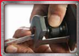
Výměna kotouče bez nástroje
