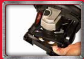
Magnetické rozhraní bez použití nástrojů
