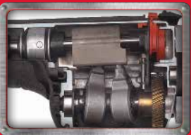
Mechanismus protizávaží zajišťuje nízké vibrace - 12,5 m/s²
