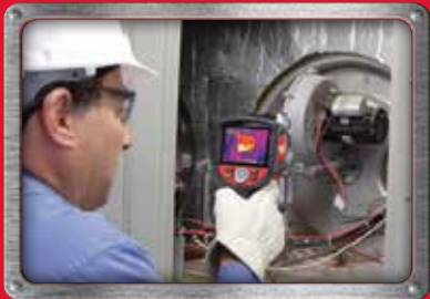
Pro diagnostiku problémů s motory
